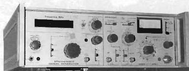
RACAL 9061 generatore di segnali 4MHz+520 MHz AM-FM sintetizzato Lit. 2.100.000 + IVA
