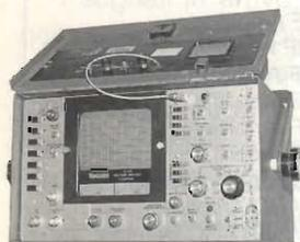
Texcan AL51A Analizzatore di spettro portatile a batterie 4 MHz+1000 MHz tubo persistenza TF 500Hz min span 2 kHz demodulazione AM-FM demodulazione video altoparlante incorporato Lit. 3.300.000+IVA
